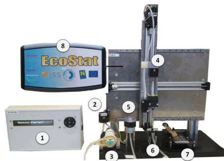
Abbildung 3: Übersicht über das modulare Konzept des Biosensorsystems mit „Eco-Con“, „EcoBot“ und „EcoStat“: 1) Stufenregler, 2) Drucksensor, 3) peristaltische Pumpe, 4) Z-Kopf mit Wasserdüse und Pipette, 5) Filtereinheit mit Inkubator, 6) Reservoirs mit Wachstumsmedium und Spüllösung, 7) Siebdruckelektroden und 8) USB Potentiostat.
